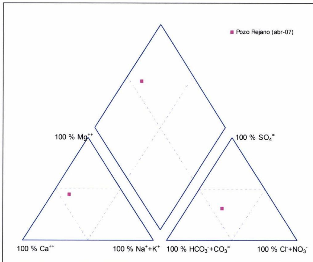
Fig. 4. Diagrama de Piper de las aguas del pozo Rejano
